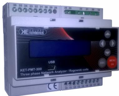
Il KET-PMT-300 è un analizzatore di rete trifase con display frontale 2 righe x 16 caratteri alfanumerici retro-illuminato. L'analizzatore è utilizzabile per lettura di correnti tramite trasduttori Rogowski, adatto a range di tensione fino a 600 Vac (50Hz o 60Hz).
